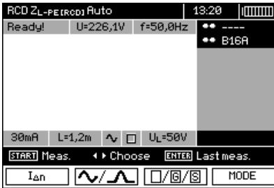
El medidor está listo para la medición. En la pantalla se pueden leer el valor de la tensión y la frecuencia de la red.
